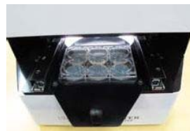
プレート用ステージは引き出し式で出し入れが容易
