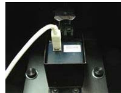
CCDカメラの位置と高さは調節が可能
