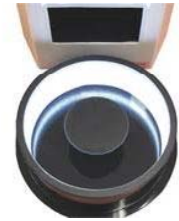
リング状のLEDライトで均一にステージを照射
