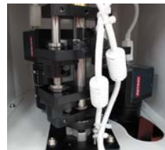
CCDカメラはシャーレ用とプレート用の2台が付属
