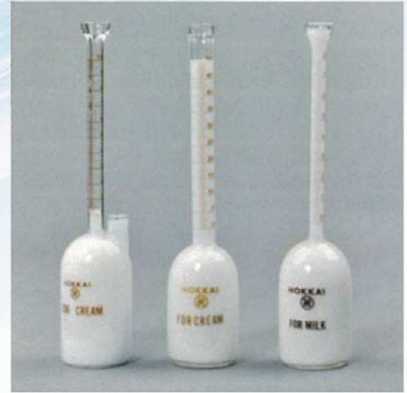
アイス クリーム用 10% バブコック クリーム用 60% バブコック 全乳用 0~8%
