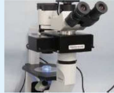
倒立顕微鏡セット例 (オリンパス CKX41)
