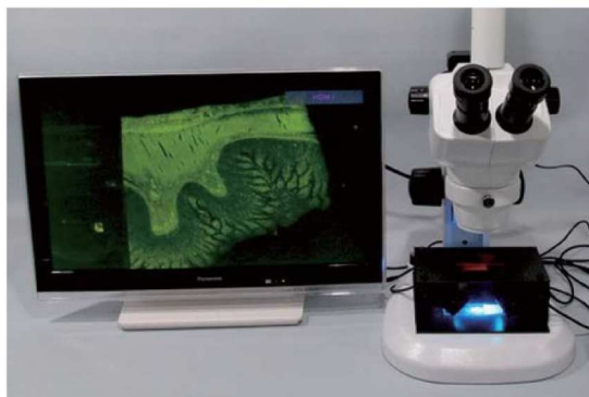
*顕微鏡に蛍光ユニットとHDMIカメラを接続して撮影した例
