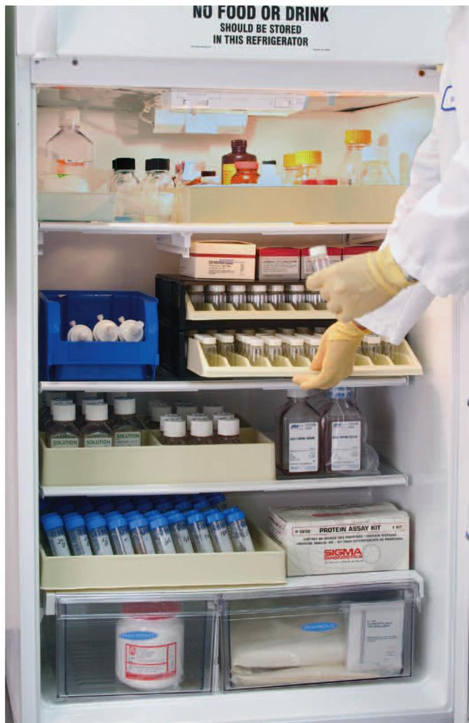
Refrig/Arranger保管トレーには、溝タイプと格子タイプがあります。溝タイプは3種類（溝幅1.9cm、3.2cm、4.8cm）、格子タイプは2種類（1.9×1.9cm、3.2×3.2cm）あります。溝タイプのトレーは、損傷を防ぐため前面が斜めになっていて、ラベル貼付にも便利です。
