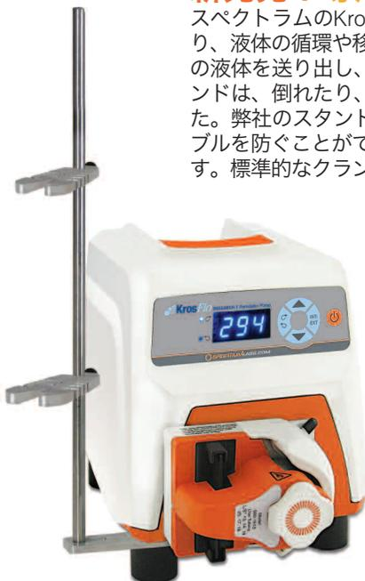
可変速KRIポンプ（100あるいは600RPM）は、順回転、逆回転の切替が可能で、デジタルキーパッドによる正確な速度調節を特長としています。より多くの流量を確保したり、2本の流体を同時に流したりする必要がある場合には、2台目のポンプヘッドを取り付けることも可能です。好みのチューブ径を選ぶことにより、最適の流量を実現できます。
